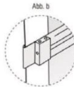
Bringen Sie nun die 4 Abdeckkappe 12 an den Spannschienenkrallen sowie je 2 Abdeckkappen 13 + 14 an den Haltebügeln oben und unten an.
