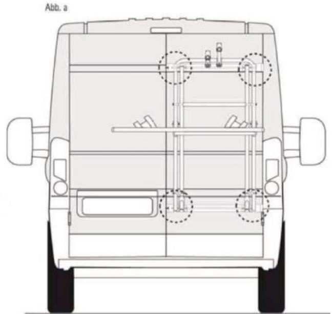
Prüfen Sie bitte nach der Montage alle (auch die vormontierten) Schraubverbindungen nochmals auf Ihre Festigkeit! Wiederholen Sie diese Prozedur nach spätestens 50km Fahrstrecke noch einmal!
